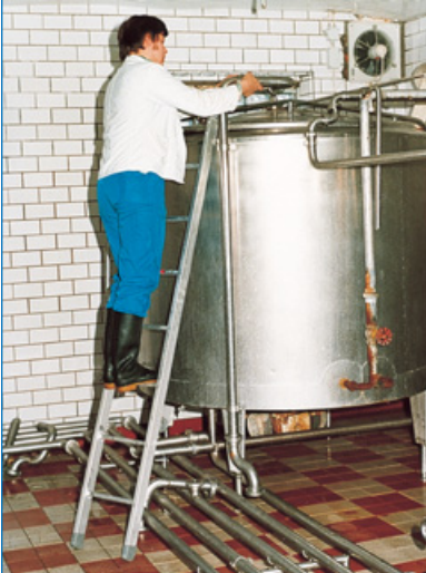
Bild: 31. Leiter mit Einhängenvorrichtung am Behälter
