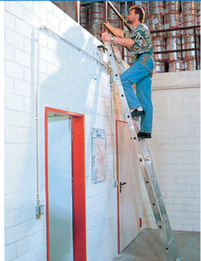
41. Eingehakte Anlegeleiter zum Übersteigen auf erhöhte Flächen mit Geländer als Haltermöglichkeit
