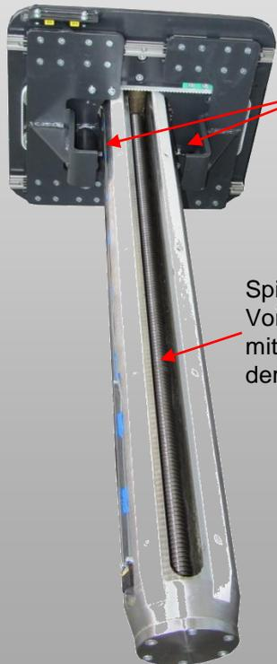
Elektrisch betätigte Spannklaue zum Andocken der Spulen (Nut in Spulen erforderlich)
