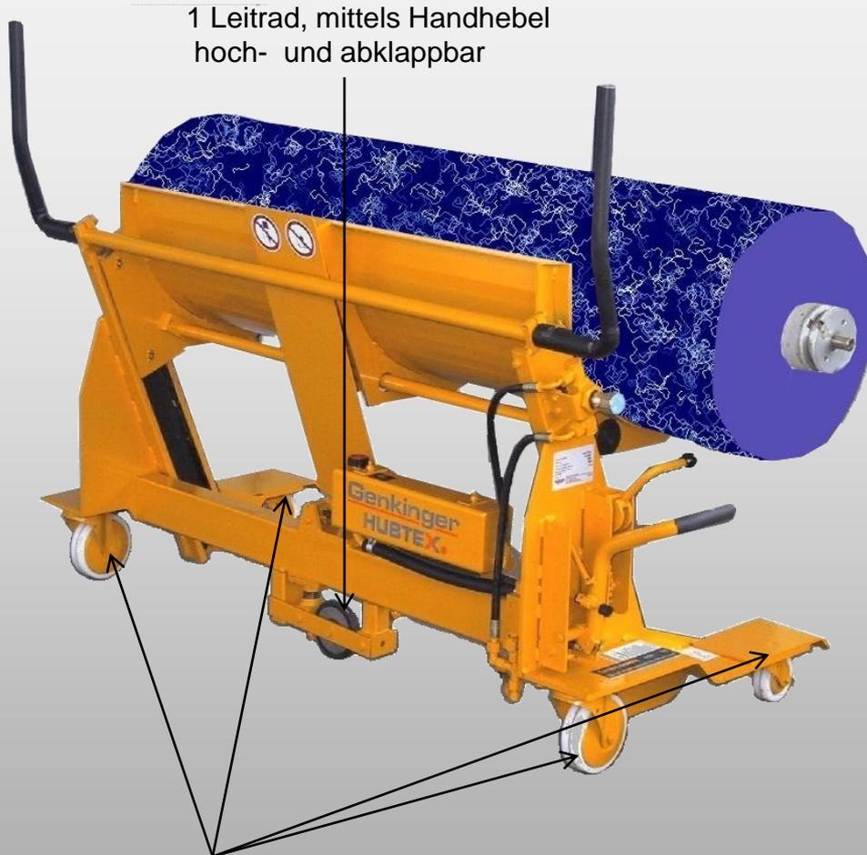
1 Leitrad, mittels Handhebel hoch- und abklappbar
