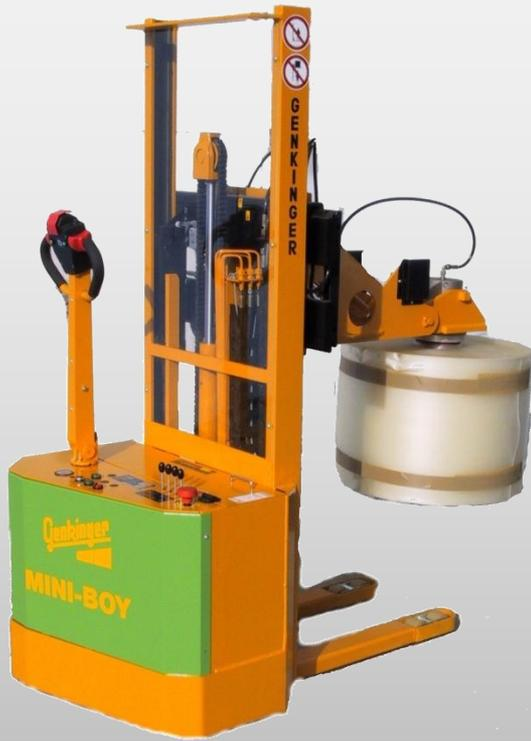
Mit dem Gerät werden Folienrollen in liegender Position von einer Europalette genommen, angehoben, in die vertikale Position geschwenkt und an eine Produktionsmaschine übergeben
