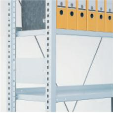
Aktenböden 30 mm dick, Sicherheitskantung vorne, **rückseitig mit Anschlag**, Boden und Stützrahmen schliessen bündig ab. Diagonalverstrebung mit Spannschloß, verzinkte Ausführung, erforderlich in jedem zweiten Regalfeld.
