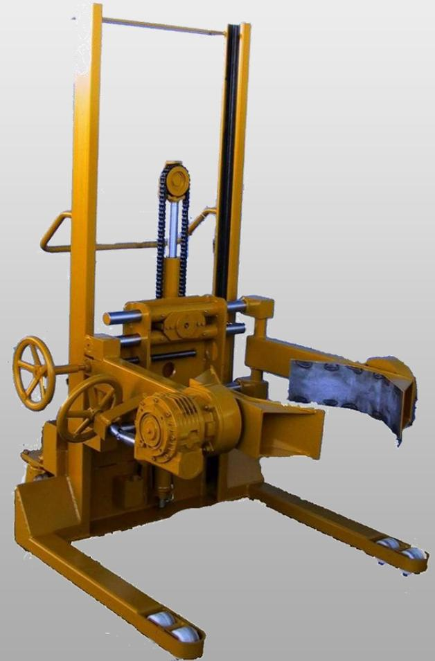
Gerätetypen **BEK** und **FEK** mit mechanischen Greif- und Kippvorrichtungen
